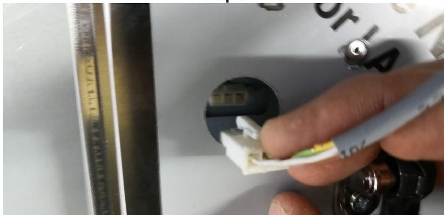
INTRODURRE IL CONNETTORE ALL'INTERNO DEL FORO POSIZIONATO AL DI SOTTO
