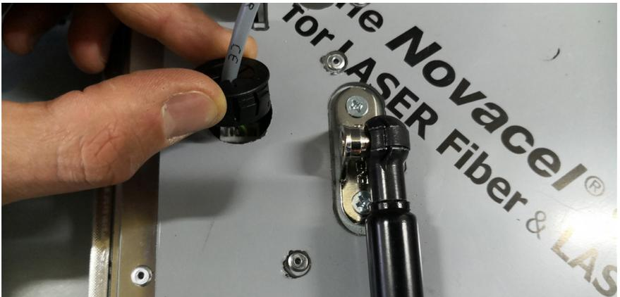
FISSARE IL PASSACAVO ALL'INTERNO DEL FORO DI CONNESSIONE
